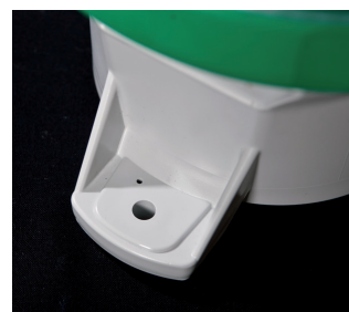
Instalación Se puede instalar en la estructura usando 3 pernos M6 en un diámetro de 150 mm.
