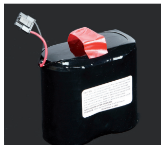
Batería de SLA Pack de baterías reciclables primeras en su clase con rango de temperaturas extremas; se cambian sin usar herramientas y tienen una vida útil de 5 años. Indicador del estado de las baterías integrado (bien, cargar, bajo o reemplazar). Muestra el voltaje real de las baterías.
