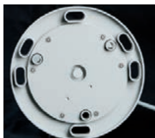
Instalación La placa base de la LED110 se puede instalar en la estructura usando 3 o 4 pernos M12 en un diámetro de 200 mm o 3 pernos M8 en un diámetro de 150 mm.
