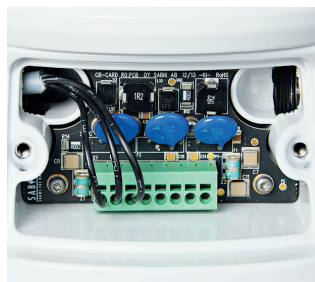
Conexión de los cables Conexión a un bloque de terminales de tipo resorte.
