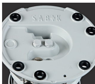
Instalación La placa inferior se puede instalar en una estructura con 3 pernos M12 o 4 pernos M12 en un diámetro de 200 mm.
